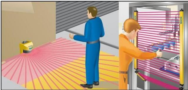
Bild 1: BWS-Beispiele Laserscanner und Lichtvorhang
